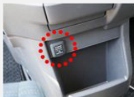
①シガーソケット背面で裏取り配線
