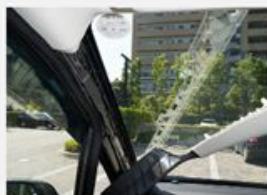
④ピラーを外し、配線が見えないようにピラーの内側に配線を固定。
