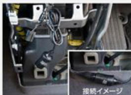
③シガーソケット背面の電源コードを分岐し、シガーソケットを増設。ドライブレコーダーと接続。
